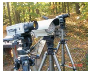
Noćni rad pod IR svjetlom, IR reflektor VR67LC - 8mm/F1.4 objektiv
