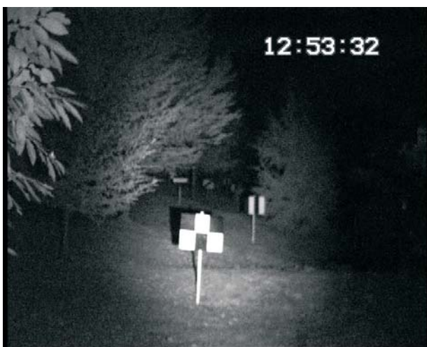
Noćni rad pod IR svjetlom, IR reflektor VR67LC - 5mm/F1.4 objektiv
